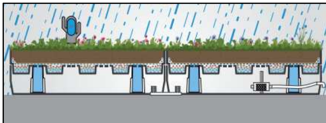
> Toiture végétalisée à Mions et schéma de fonctionnement (projet GEPETO, Hydroventiv®)
